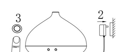
5. Подключите блок питания и нажмите кнопку включения прибора. Нажмите кнопку для включения подсветки
