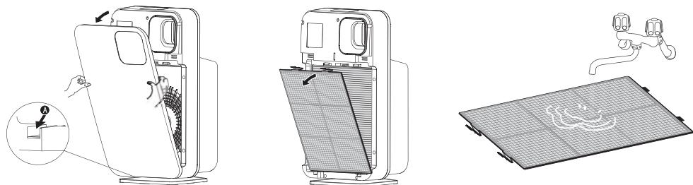
Рекомендуется производить очистку предварительного фильтра не реже 1 раза в месяц.
