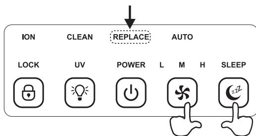
**Примечание.** Заменяйте фильтр, когда загорается соответствующий индикатор замены фильтра. Если Вы замените фильтр до того, как индикатор замены фильтра начнет мигать, то устройство будет продолжать отсчет времени «жизни» предыдущего фильтра. В результате индикатор замены фильтра начнет мигать раньше положенного времени.
