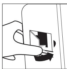
Для обеспечения оптимального функционирования прибора, пожалуйста, производите очистку датчика раз в два месяца. Если очиститель используется в очень пыльном помещении, то очищайте датчик чаще.
